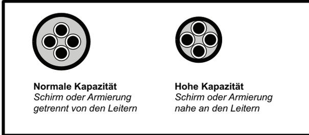
Die in Abschnitt 4.5.1 *Kabeltypen und -längen* auf Seite 56 angegebenen maximalen Motorkabellängen sind geschirmt und enthalten vier Adern. Typische Kapazitäten für diesem Kabeltyp sind 130 pF/m (d. h. von einem Leiter zu allen anderen, die mit dem Schirm zusammengeschlossen sind).
